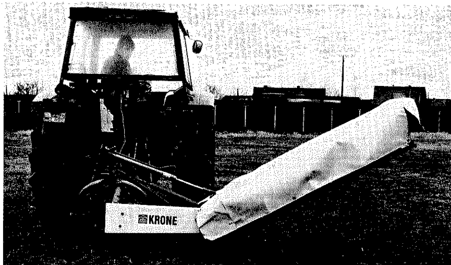
Am Feldende nur Zugzylinder betätigen. Hydraulik für Unterlenker bleibt unberührt.
