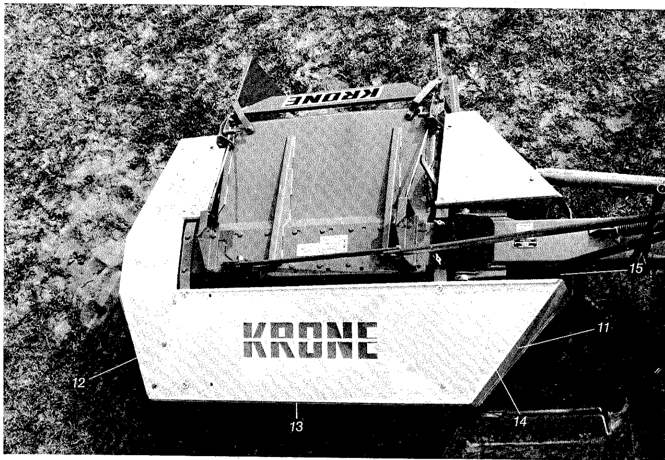
Kunststofftuch rundum (11) mit Klemmbänder 12; 13 + 14 verschrauben. Scheibe (15) 11 x 36 von hinten montieren.
